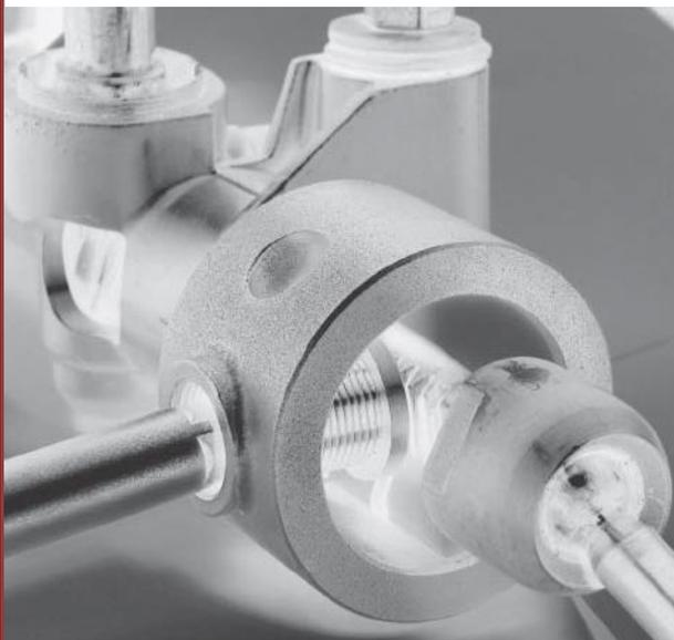
HERCULA wird auf die Leiste gelegt und mit Schraube mit Innensechskantschrauben 1/2" befestigt. Abhängig von dem Fahrzeugstyp und des Platzes, wird die Sperrung der Leistendrehung mit typischen Regulatoren Quadrat 1/2" durchgeführt. Nach dem Anziehen der Stange mit richtigem Moment wird der Griff gelockert und von der Leiste weggenommen.
