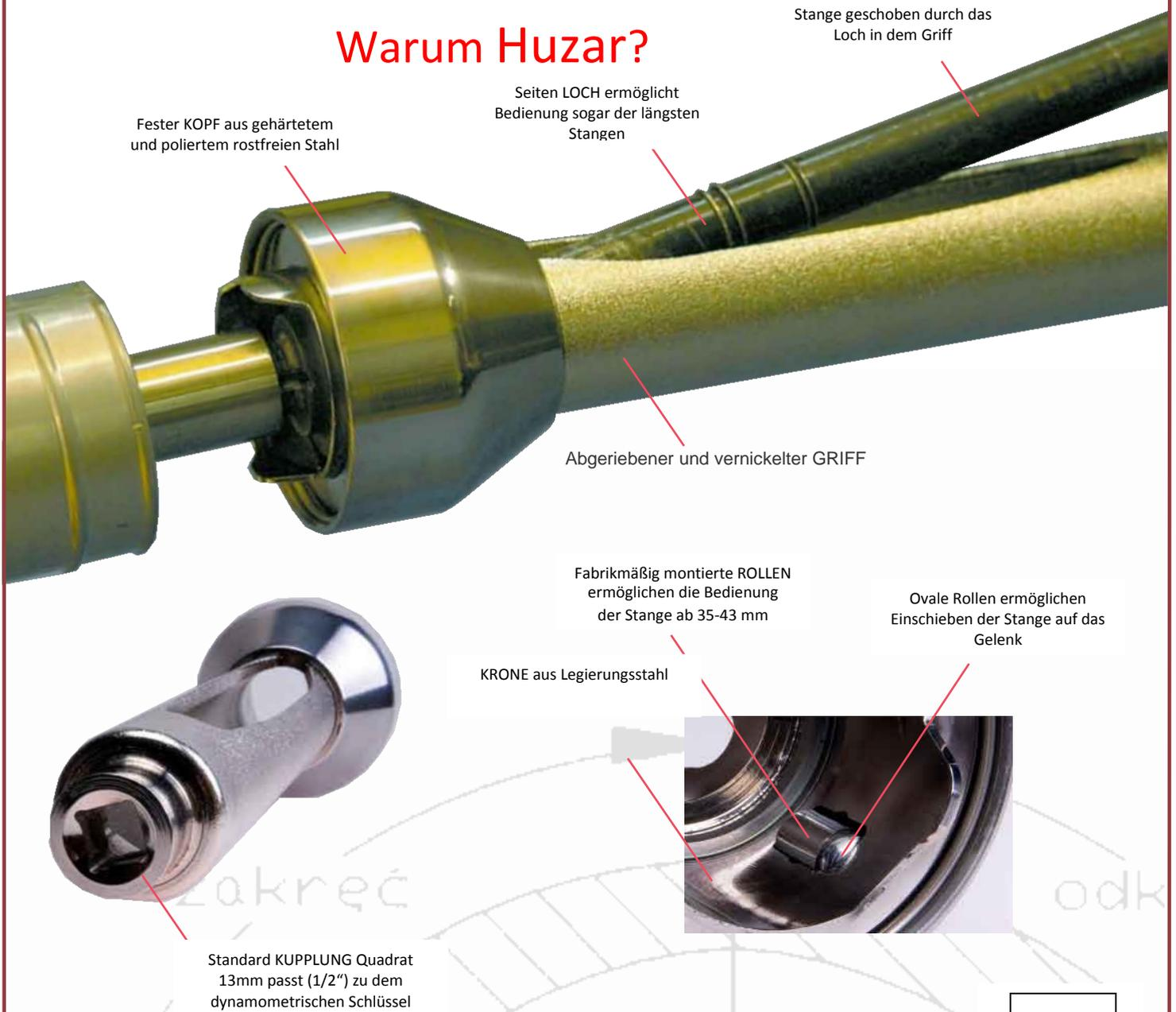
Schlüssel Huzar ist ein Werkzeug zum richtigen Austausch der Lenkstangen.
